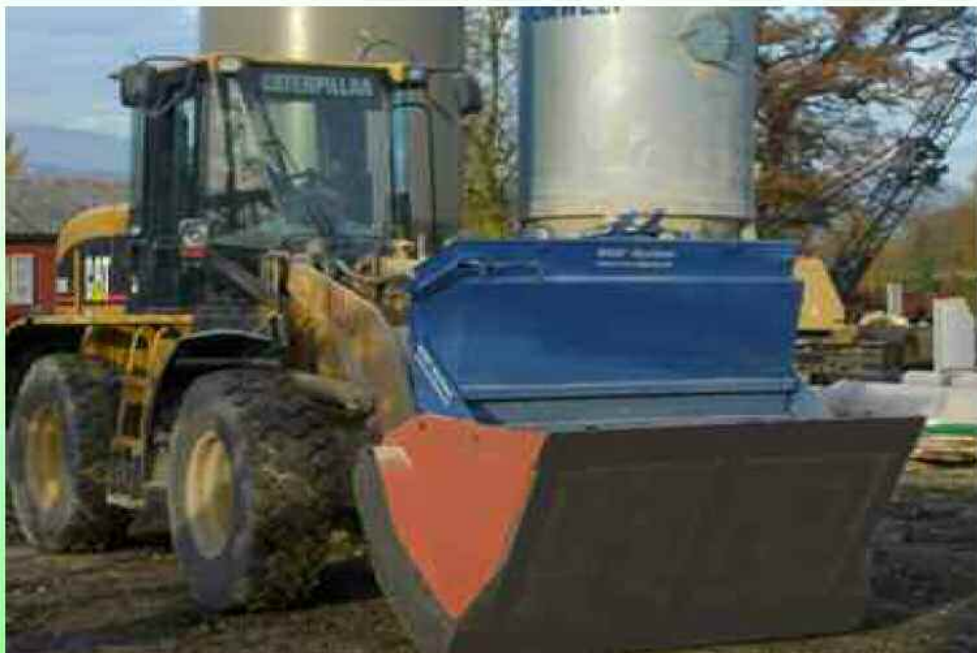
Kombiniertes Gerät (Separator / Radlader mit Dosiereinrichtung)
